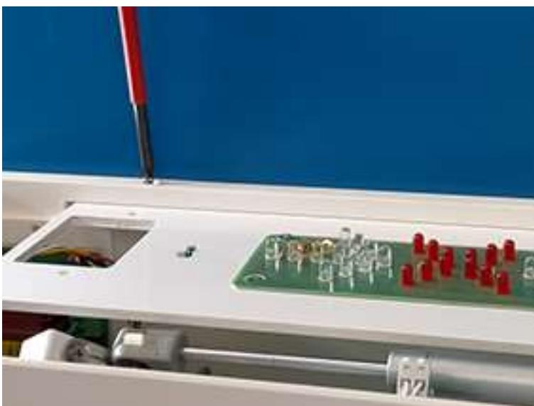
Posizionare il pannello delle frecce a leds facendo coincidere le sedi delle viti
