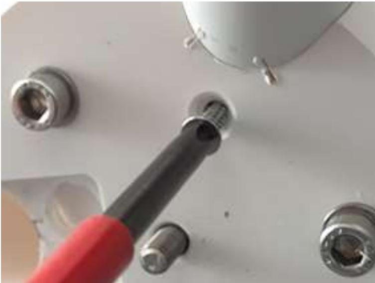
Avvitare la vite di fissaggio
